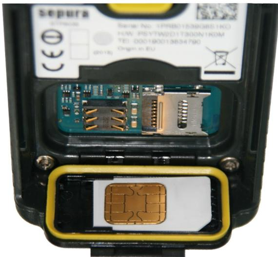
Die SIM-Karte mit dem Chip nach oben und der abgeschrägten Ecke links in den SIM-Kartenhalter legen.
