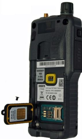
Die SIM-Karte mit dem Chip nach oben und der abgeschrägten Ecke links in den SIM-Kartenhalter legen.
