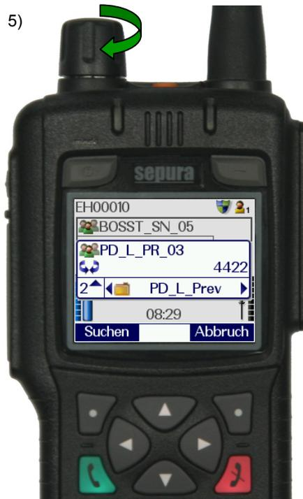
Gruppen der 3. Ebene auswählen, Auswahl der Gruppe über den Navigations-Drehknopf mit anschließendem Betätigen der PTT-Taste
