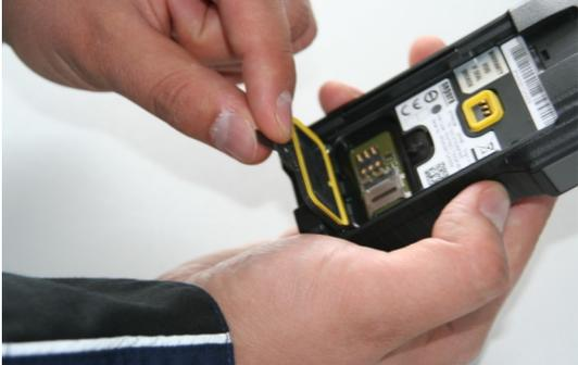
Zum Entriegeln des SIM-Kartenhalters an der Haltetasche der Abdeckung oben leicht ziehen.
