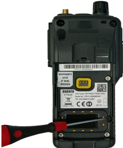
Öffnen Sie den Deckel des SIM-Kartenhalters mit einem Kreuzschlitz Schraubendreher (Ø - 2mm)
